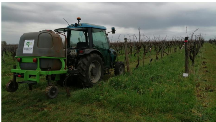
Photo 1 : applicateur à chélate de fer utilisé pour injecter Assimil K Starter dans le sol lors l'essai à la SCEA Jauré.
